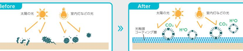
光触媒は「それ自体は変化しないが、光を受けることで反応を促進するもの」と定義づけられます。酸化チタンを主原料とする光触媒溶液は、太陽光や蛍光灯などから出る光線を当てるによって、その表面で化学反応を起こし、有機物などを分解する特徴があるとされています。
